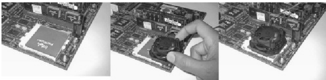
Figura 1.2 Acoplado um microventilador no processador
